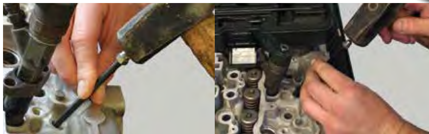
GLÜHSPITZE IN DEN ZYLINDER STOßEN
